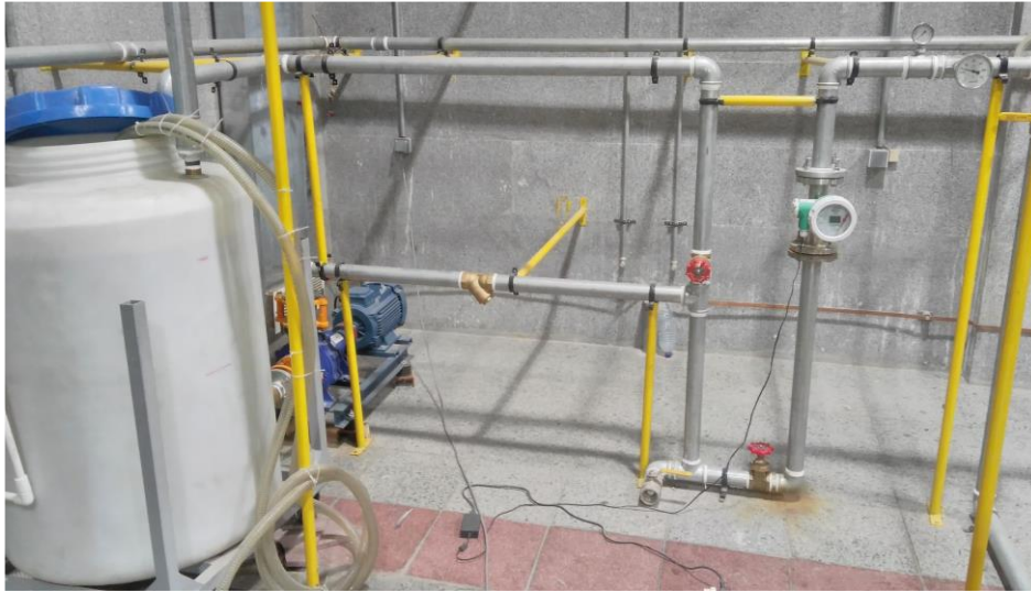
شکل ۱- نمایی از حلقه جریان دوفازی ساخته شده شامل پمپ، لوله‌ها، دبی‌سنج دیجیتال و سایر تجهیزات
